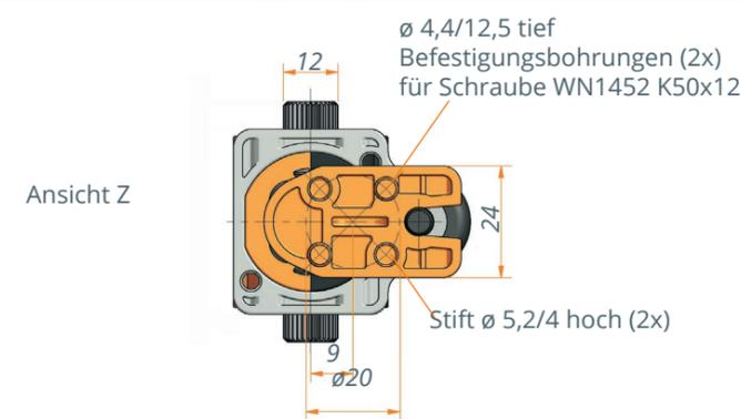
Umlenkgetriebe mit Bremse 3052.00-V02AXXX
