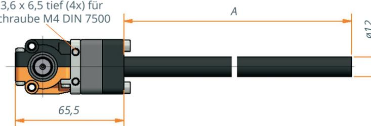
Alternativ: Umlenkgetriebe und Bremseinheit 3052.00-V02AXXX
