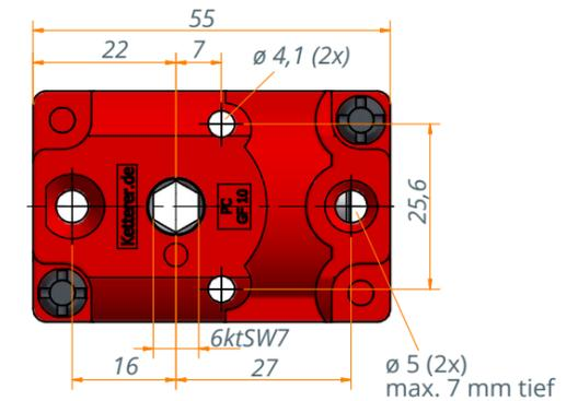
3045.00-3002 - Übersetzung 2:1 (Antrieb : Abtrieb)
